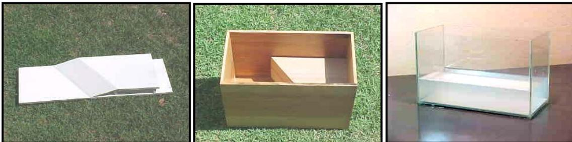
Figura 8: Fotos mostrando as montagens experimentais. Da esquerda para a direita, rampa para “refração” de corpúsculo, caixa para refração de frente de onda mecânica e aquário para refração da luz.
