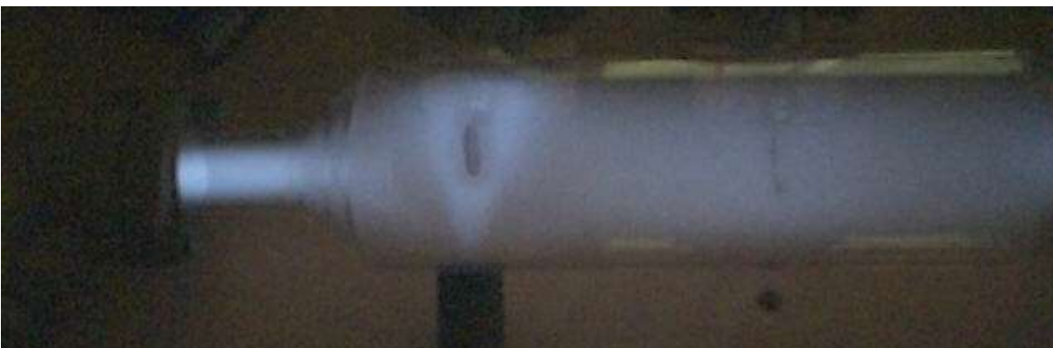
Foto 5 - Demonstração das linhas de campo magnético de um ímã cilíndrico. É fácil perceber a forma adquirida pelo plasma. Temos a impressão de um "fluxo" de plasma saindo do ímã.
