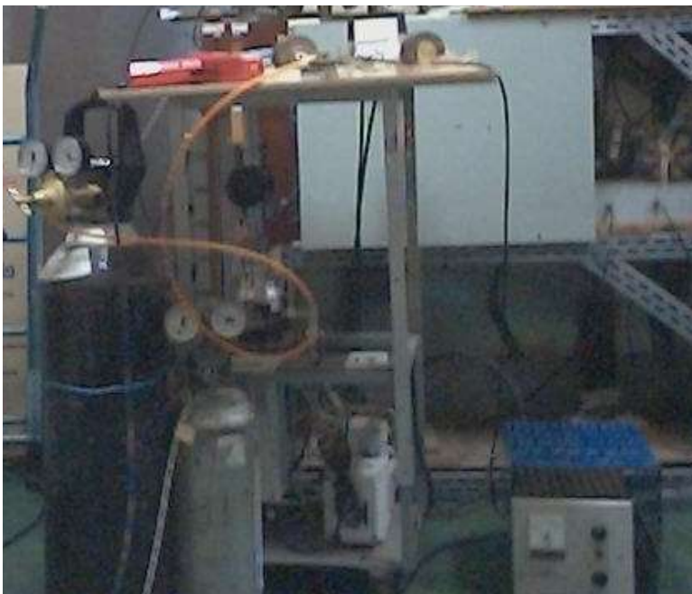
Foto 1 - Vista frontal da montagem, com destaque para os balões de gás e para o gerador de RF
