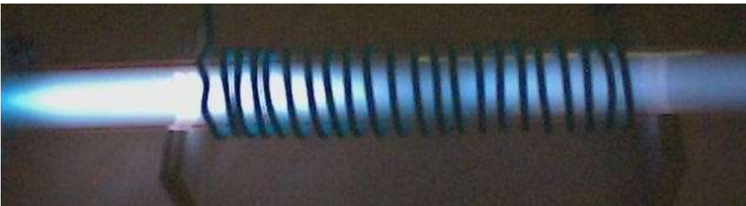
Foto 4 - Plasma de Hélio sendo produzido pela bobina na câmara menor. Podemos perceber a cor verde do plasma de Hélio.
