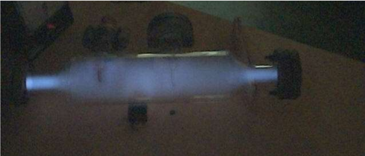
Foto 6 - Agora o ímã foi colocado de lado. Percebemos claramente a forma adquirida pelo plasma. A impressão que temos é que existe um "fluxo" de plasma de uma extremidade até a outra. Esse fluxo se torna menos denso à medida que se afasta do ímã.
