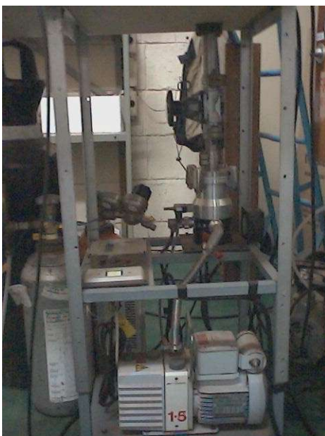
Foto 2 - Vista lateral da montagem, com destaque para as bombas mecânica (em baixo) e turbomolecular (acima)
