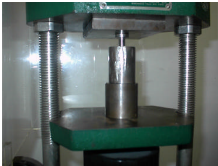
Figura 19: Esquema de disposição dos cilindros. A base da matriz está em contato com a parte semi vazada do outro cilindro
