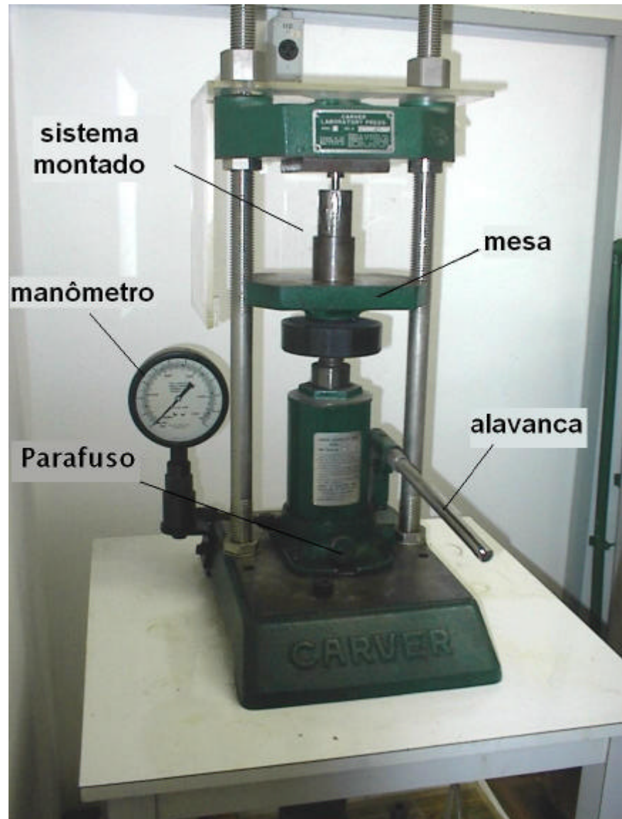
Figura 16: Prensa Hidráulica e suas partes identificadas
