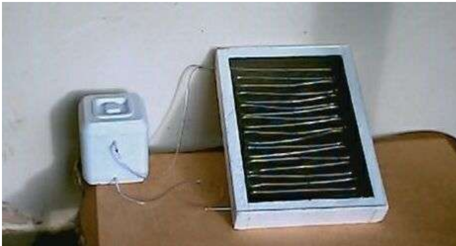
Fig. 6: Foto do reservatório térmico e coletor solar.
