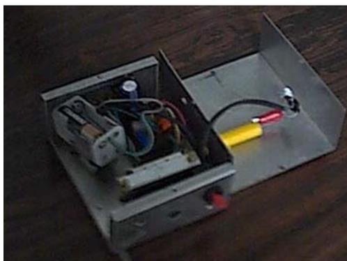
Figura 3: Caixa com o porta pilha
