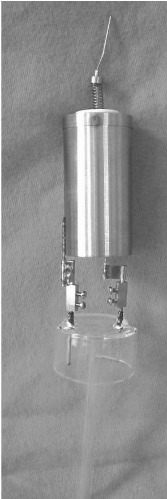
Figura 08: Montagem parcial da válvula diodo.
