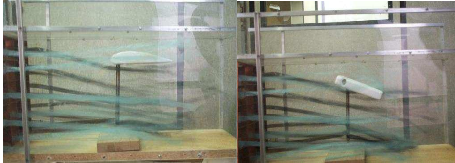
Figure 6: Fluxo no túnel, note que há fitas que ficam juntas da parede indicando que aí a velocidade do fluido é zero e que antes de chegar ao objeto as fitas demonstram um fluxo laminar, pois estão praticamente paralelas umas às outras.
