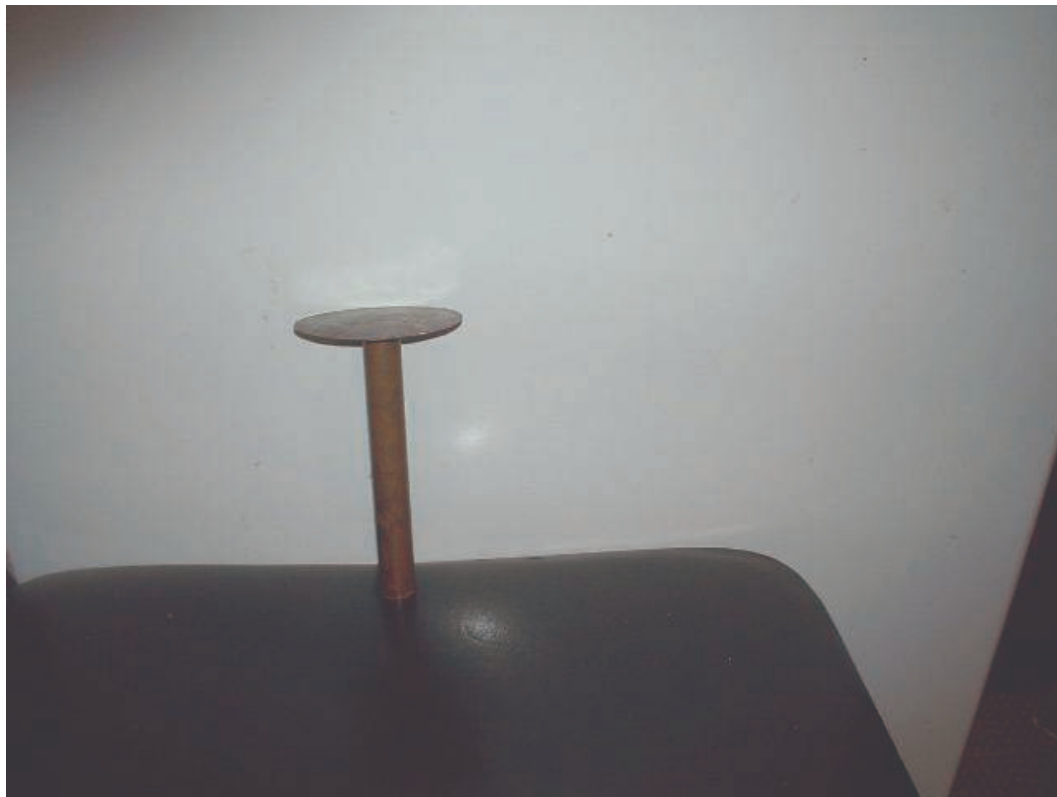
Figura 3 – Tubo de cobre, já soldado à placa de cobre.
