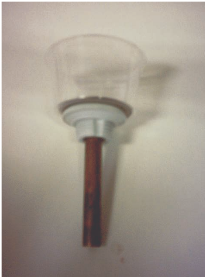
Figura 4 - O tubo de cobre, já soldado à placa, é inserido no recipiente plástico e na tampa da garrafa térmica.
