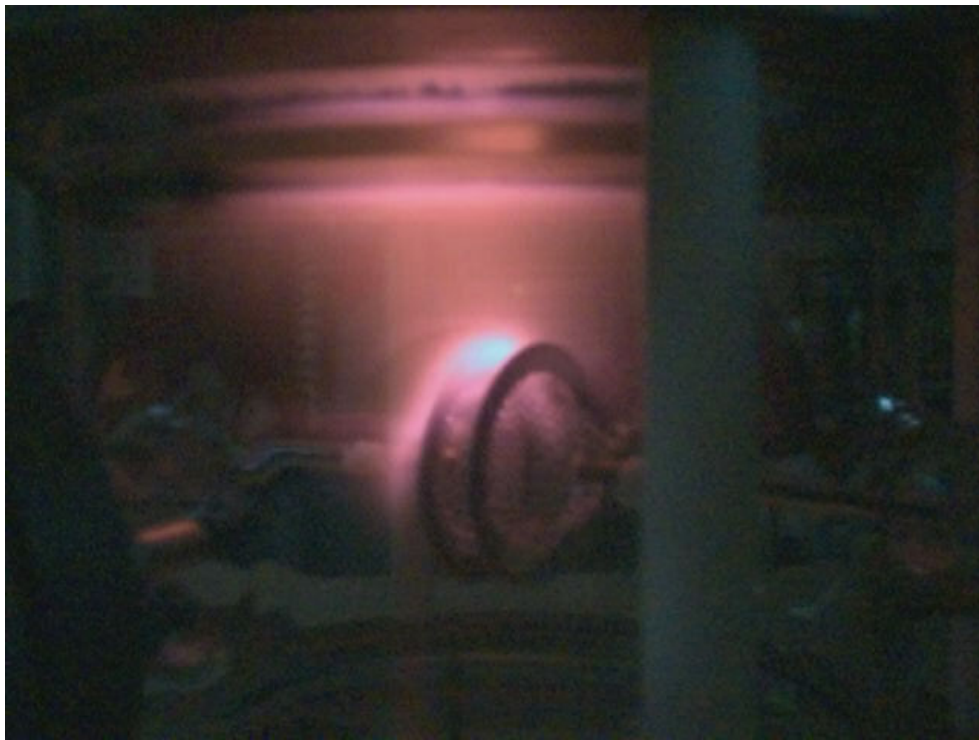
Fig. 10: Plasma se moldando ao eletrodo positivo quando há uma tensão de 50V entre os eletrodos.
