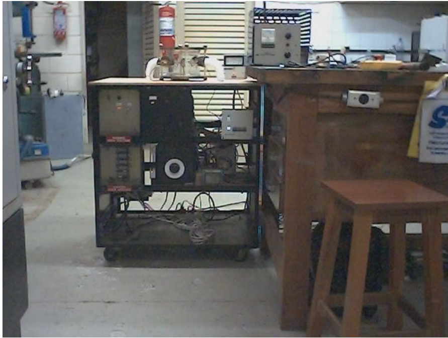
Fig. 4: Visão frontal do experimento, pode-se ver os painéis de controle do circuito, do sistema de vácuo e do pirani, o variac e o transformador. Na mesa ao lado do experimento está o gerador de RF.
