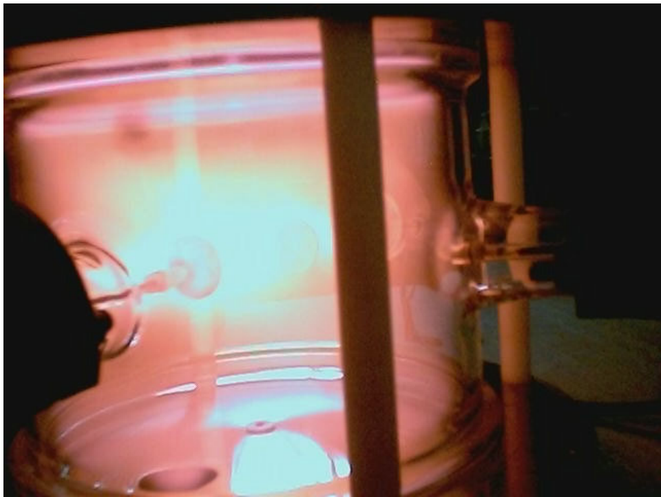
Fig. 8: Plasma no interior da câmara. Uso de moedas como eletrodos.
