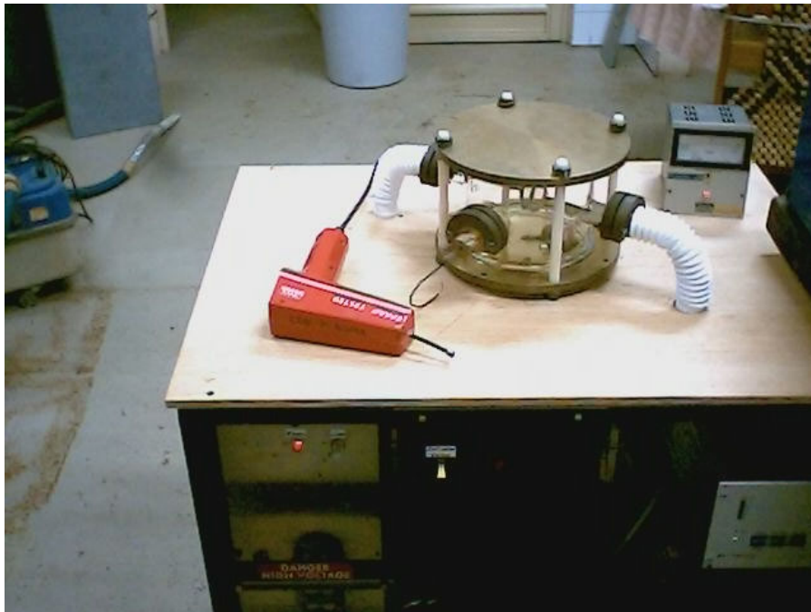
Fig. 5: Vista superior da máquina, pode-se ver a câmara, os eletrodos, a pistola, a chave geral e os painéis de controle.
