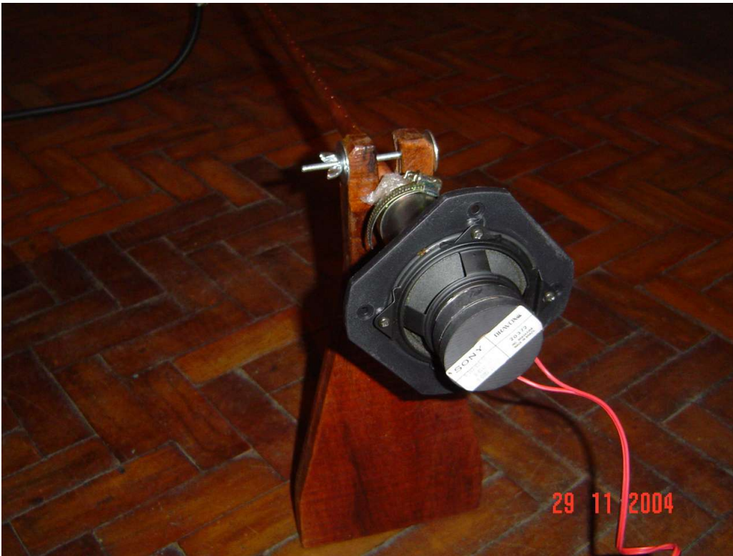
DETALHE DO ALTO-FALANTE E SUA FIXAÇÃO
