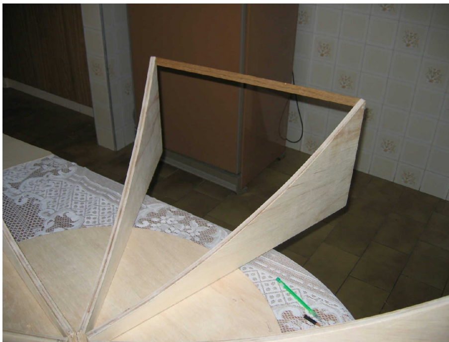
Figura 17. Pequenas ripas utilizadas para auxiliar a montagem do revestimento.
