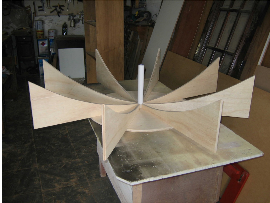
Figura 11. Espelho acústico parabólico montado (em outro ângulo).
