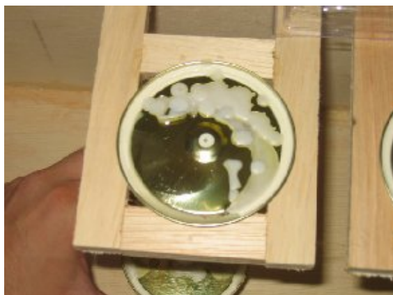
Figura 6 – Após um pequeno intervalo de tempo, grande parte da parafina já está em estado líquido.
