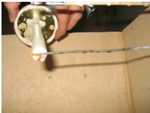
Figura 4 – O metal é exposto à chama. À medida que o calor é transmitido pelo metal, a parafina vai derretendo. Depois de um pequeno intervalo de tempo, a parafina já está totalmente derretida.
