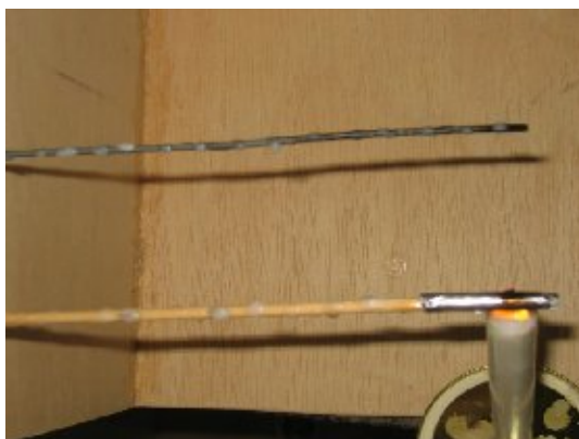
Figura 2 – Palito de madeira exposto à chama. A parafina não derrete devido à baixa condutividade térmica da madeira.
