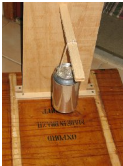
Figura 13 – Aparato para a MÁQUINA TÉRMICA. Com o vapor de água saindo pelos furos oblíquos na lata, a mesma começa a girar.
