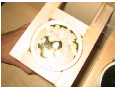
Figura 5 – Tampa metálica com parafina exposta à chama. A parafina passará do estado sólido para o estado líquido.
