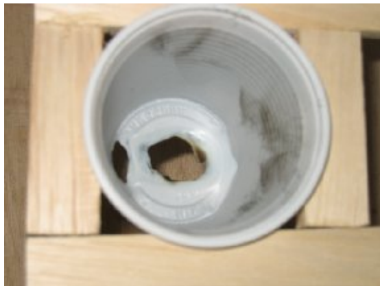
Figura 11 – Quando o copo vazio é exposto à chama de uma vela, ele derrete rapidamente.
