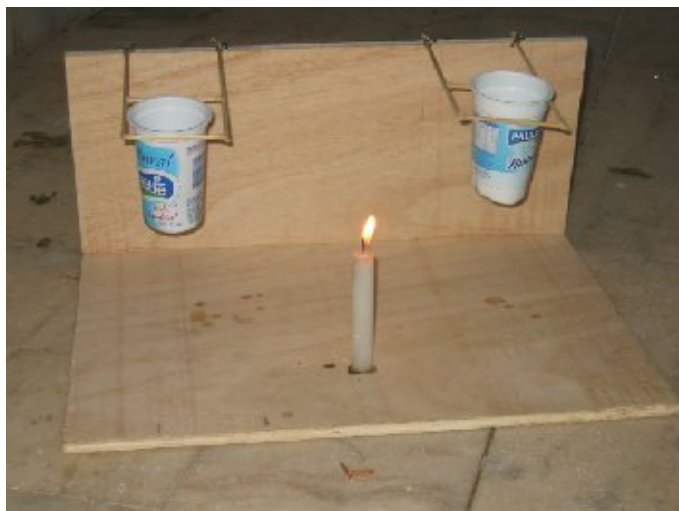
Figura 11 - Aparato experimental para o experimento de DISSIPACÃO DE ENERGIA TÉRMICA. Esse é só um exemplo de como vão ficar dispostos os apetrechos. O aparato ainda passará por acabamento.
