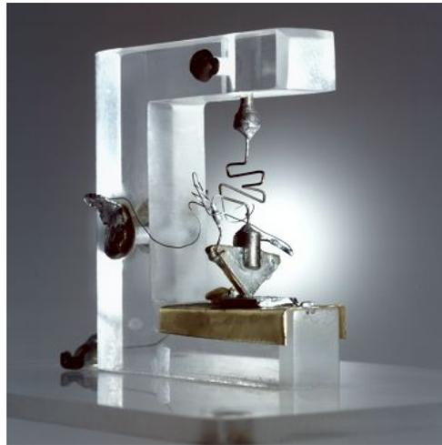
Figura 11: foto da representação do primeiro transistor.
