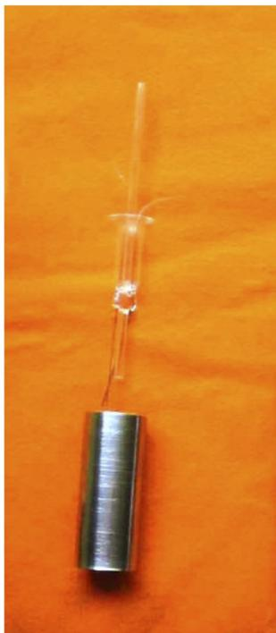
Para compor a parte superior do diodo usa-se o miolo, apenas com as hastes de suporte do filamento, de uma segunda lâmpada incandescente que foi retirado pelo mesmo método anterior. A este miolo foi soldado um fino tubo e vidro onde será conectada uma bomba que retirará o ar de dentro do diodo, fazendo o vácuo necessário para as medidas.
