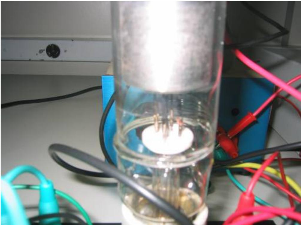
**Foto 2** – Detalhe da base do diodo, com a solda feita entre os vidros.
