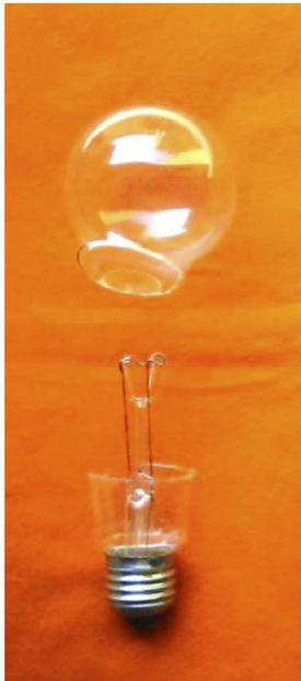
Esta é a parte inicial da manufatura. Na figura é mostrado o corte feito no bulbo de uma lâmpada incandescente: usando um disco diamantado é feito um “sinal fundo” na região onde deseja-se o corte e, por aquecimento rápido, o vidro rompe. Esta técnica foi usada afim de separar o bocal com o filamento (parte inferior). Este será o suporte do diodo onde serão montadas as outras partes.
