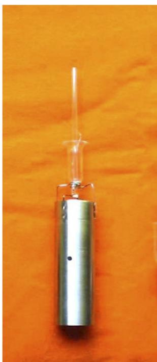
Nesta figura o cilindro é soldado aos suportes do filamento da segunda lâmpada usando a técnica da solda ponto, que consiste em soldar metais sem o uso de um terceiro metal, como o estanho, A solda é conseguida por aquecimento pontual na união desejada. Como as hastes são inseridas no vidro e se estendem até a parte externa da lâmpada, podemos usá-las para fazer as medições de ddp e/ou corrente necessárias.
