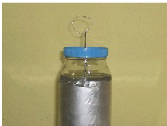
Figura 6: Garrafa de Leiden construída com um frasco de vidro. Tem um rendimento baixo
