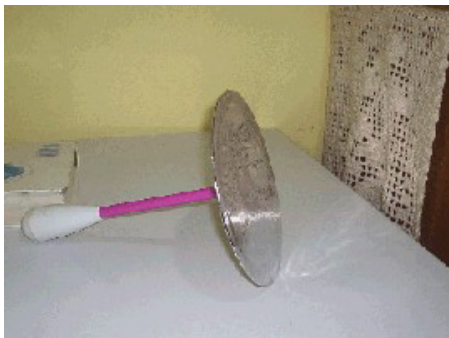
Figura 9: Eletroforo de Volta, feito com disco de papelão e um cotonete de carnaval
