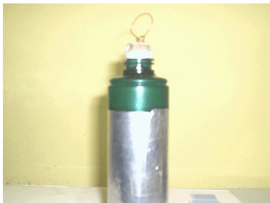
Figura 5: Garrafa de Leiden construída com materias alternativos. Repare no anel
