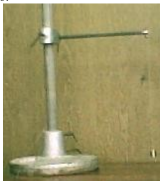
Figura 6 – O aparato experimental visto como um todo, com o pêndulo montado (canto direito da figura). A altura do suporte é regulada deslizando-se o regulador até o ponto desejado da base e, então, prendendo-o com o parafuso mostrado na parte superior esquerda (também atravessado por uma alavanca de ferro). O parafuso que prende a haste no regulador está no lado de trás, mas a alavanca de ferro que o atravessa pode ser vista um pouco abaixo do ponto onde a haste e o regulador se encontram.
