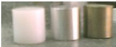
Figura 8 – Os três “cilindros” a serem usados no pêndulo, feitos de plástico, alumínio e latão. Todos eles possuem altura e diâmetro de 20mm.
