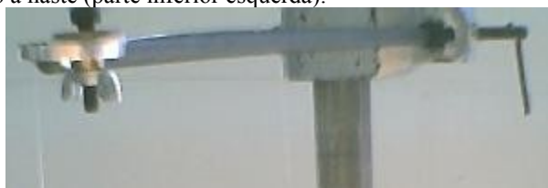
Figura 5 – Suporte prendendo o fio do pêndulo e ligado ao regulador de altura (parte superior direita da figura) pela haste. A fixação da haste no regulador é feita pelo parafuso (atravessado por uma alavanca de ferro) mostrado no canto superior direito.
