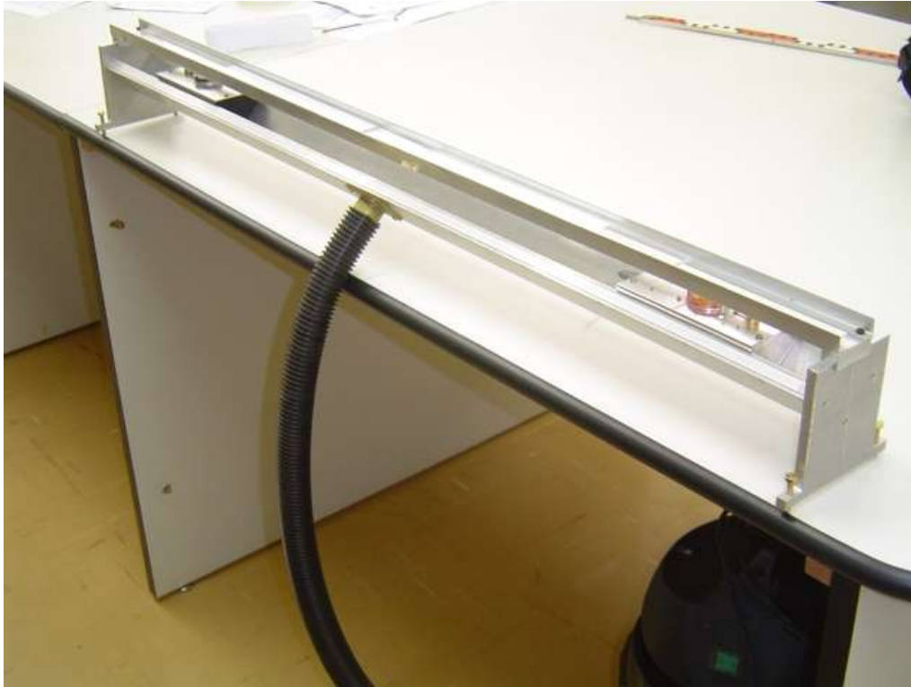
Fig.1: Foto do trilho de ar com os carrinhos ligados ao aspirador invertido.
