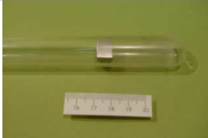
Figura 4.8. Amostra da liga TI-25 Nb selada em tubo de Quartzo.
