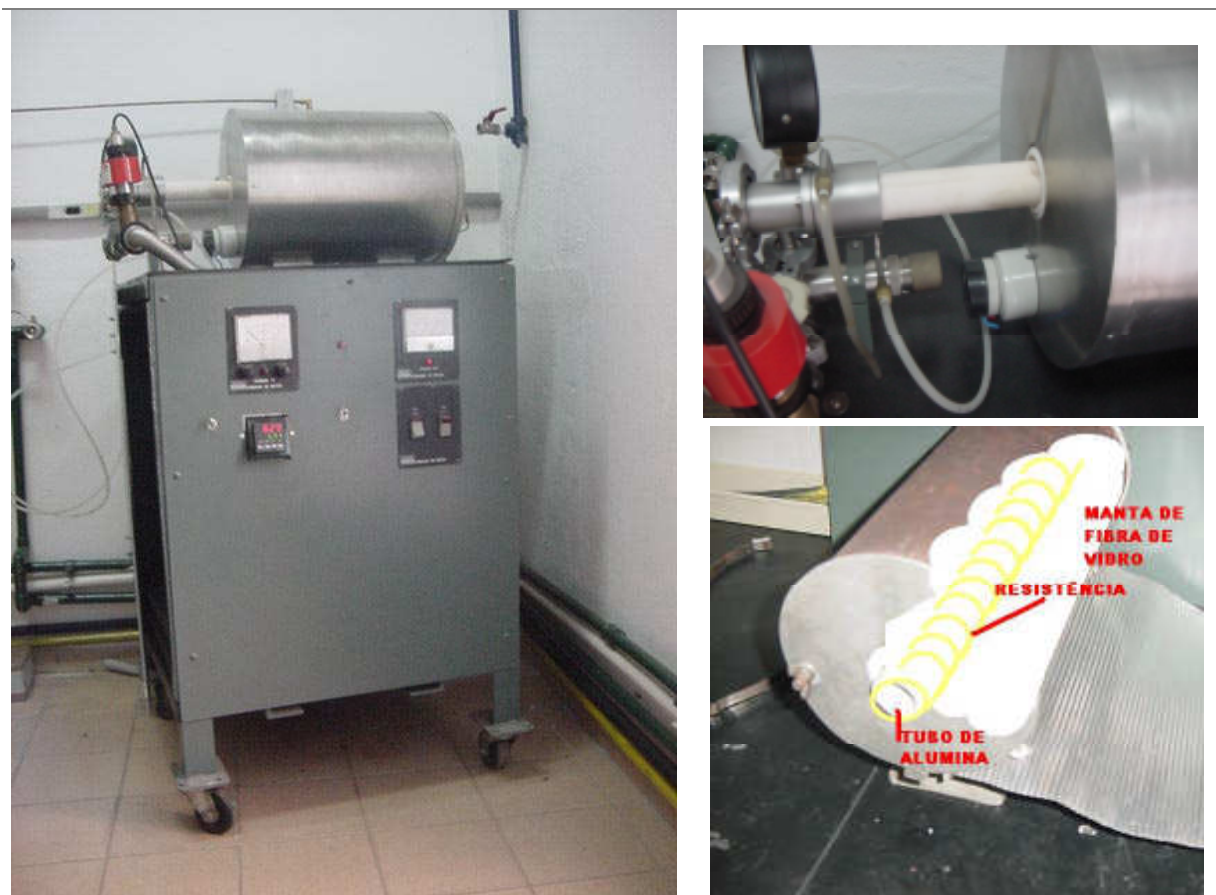
Figura 4.9. Forno de Tratamento Térmico
