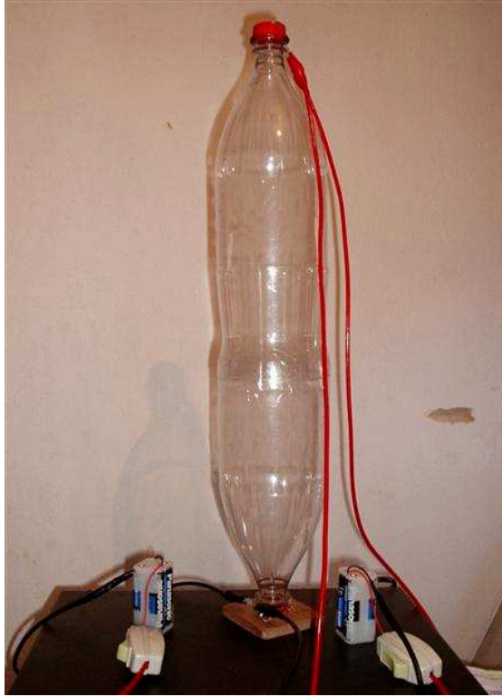
Figura B4: PET 1 com fios de contato, interruptor e pilhas para gerar correntes.
