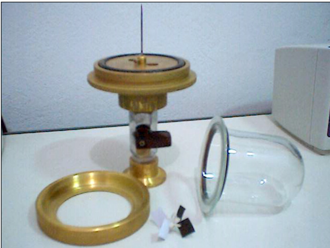
Figura 4: O conjunto completo do nosso instrumento. A base, já com a haste; o prensador, o bulbo e as palhetas.
