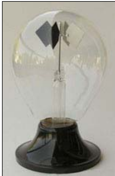
Figura 1: Uma versão moderna do Radiômetro de Crookes.
