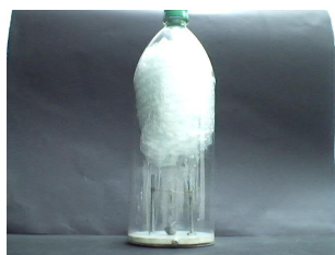
Figura 7: A garrafa cortada e, em seu interior, o pêndulo e a WebCam.
