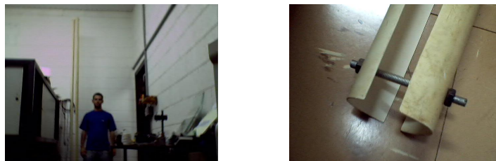
Figura 5: O guia de queda. a) Altura de aproximadamente três metros b) Parafusos para manter o guia coeso e, ao mesmo tempo, permitir uma desaceleração suave da garrafa.
