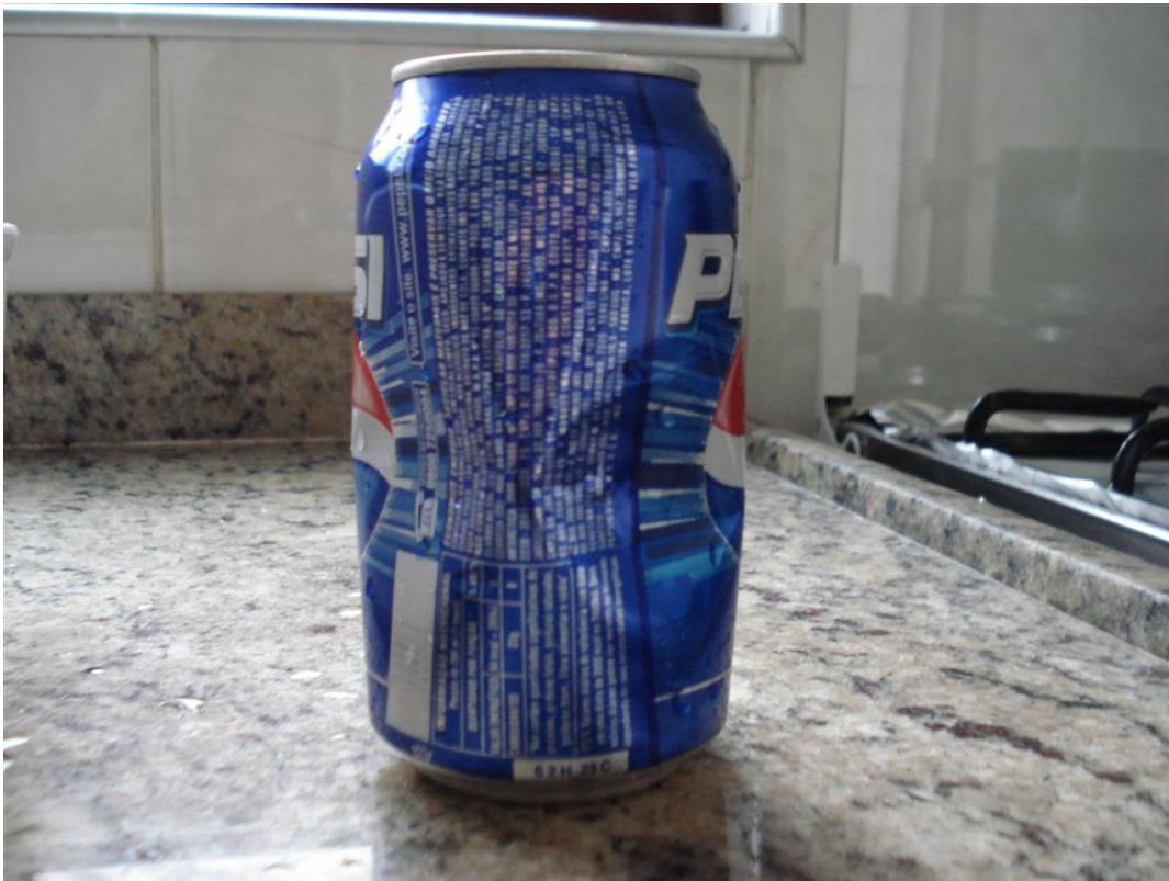
Fig. 5 - ...e é deformada devido à existência da pressão atmosférica.
