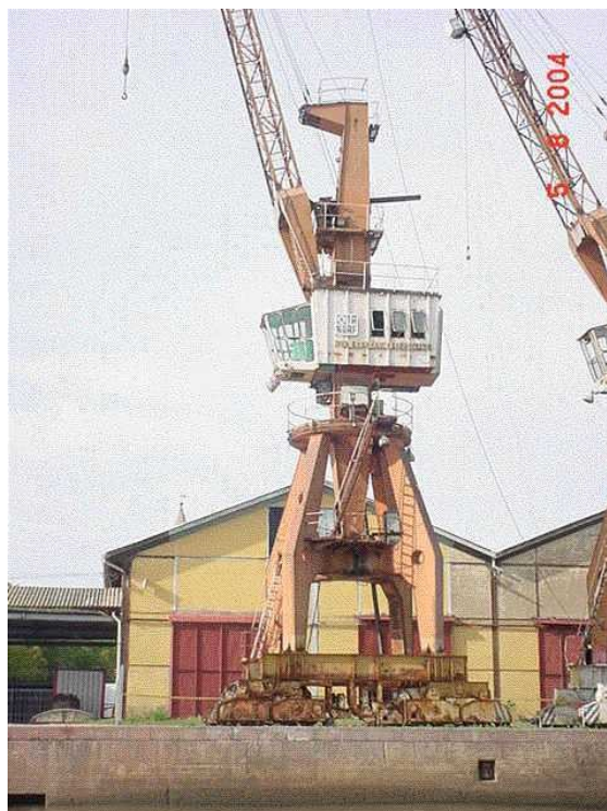
Figura 1: Guindaste elétrico de pórtico da marca KRANBAUEBERS tipo EWK cap. 3,200 KG.
