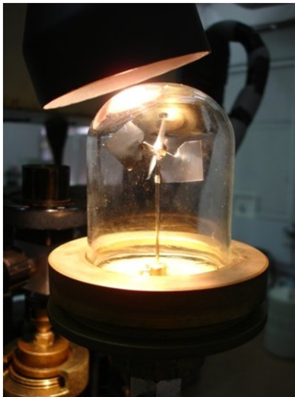
Figura 2 - Montagem realizada em outro semestre na mesma disciplina, com as palhetas de alumínio confeccionadas por mim.
