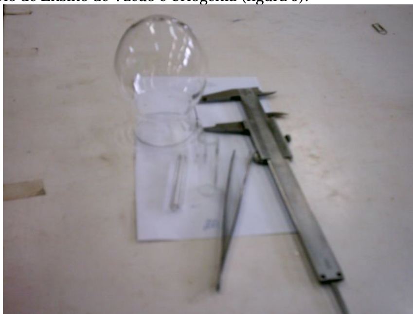
Figura 5 - Bulbo, base e haste, peças para a montagem do radiômetro. Trabalho realizado na oficina de vidraria do IFGW.
