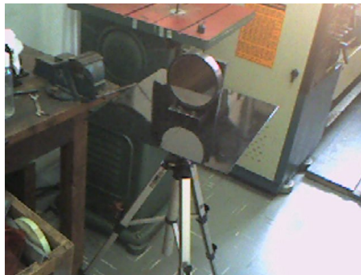
Fig.28: Montagem do suporte do espelho côncavo.
