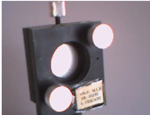
Fig.32: Suporte do espelho plano permite um ajuste fino da orientação.
