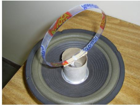
Fig.5 – Aro de plástico encaixado no suporte.
