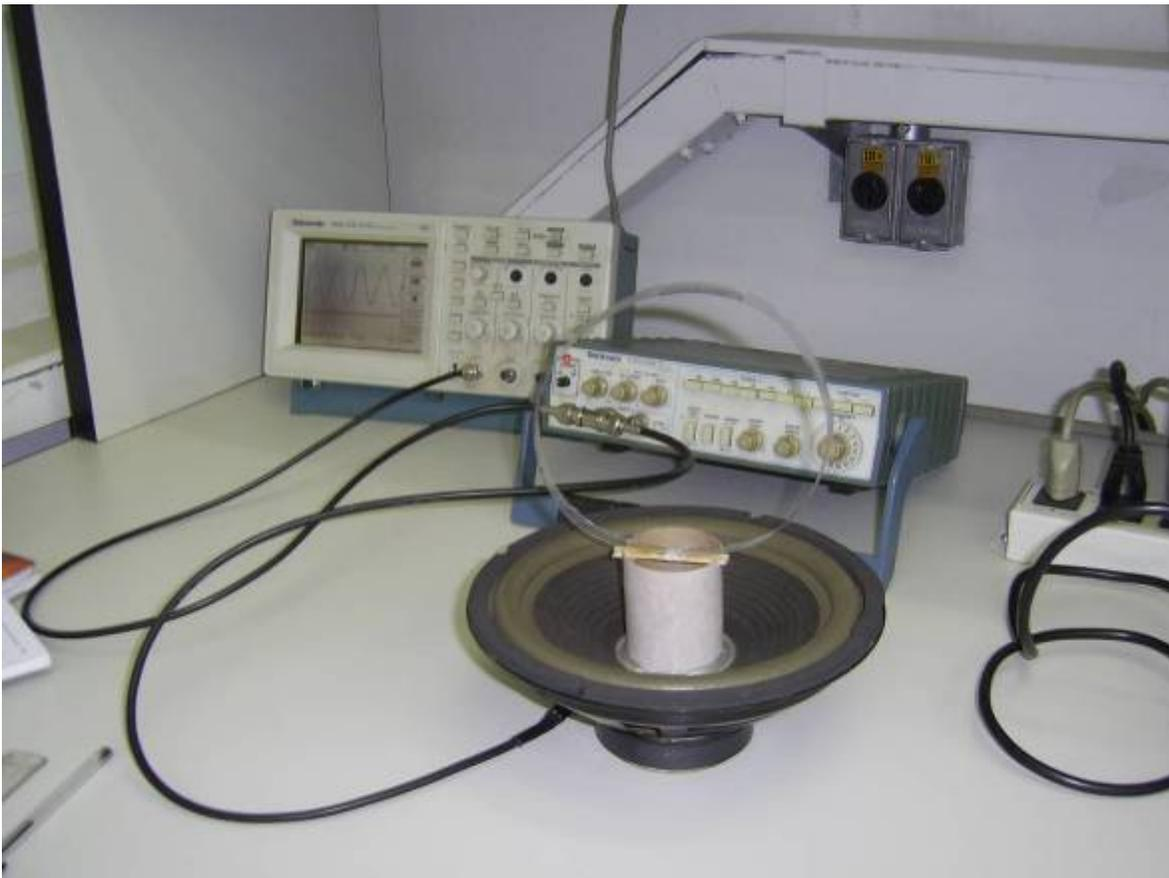
Fig.6 – Aparato experimental, o auto-falante está ligado a um gerador de frequências e a um osciloscópio.
