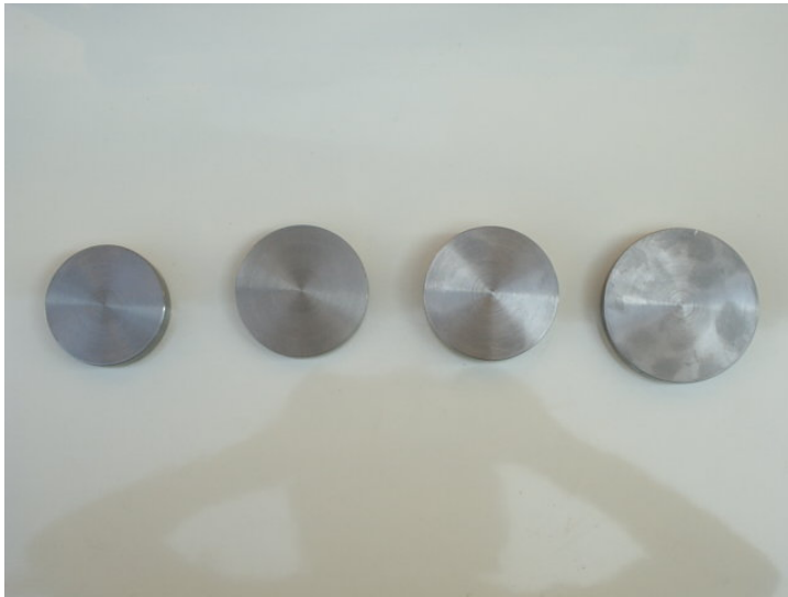
Figura 2: Os 4 discos utilizados. Da esquerda pra direita temos diâmetros (mm): 1-69.0; 2-75.5; 3-76.0; 4-89.0;
