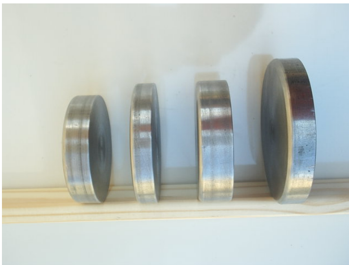
Figura 3: Os 4 discos utilizados (vista lateral). Da esquerda pra direita temos espessuras (mm): 1-15.0; 2-12.5; 3-19.5; 4-14.5;
