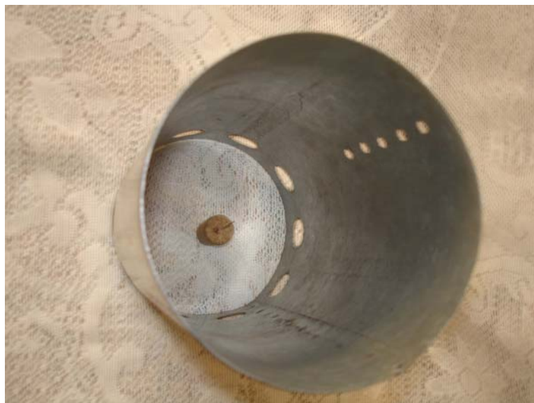
Figura 7 – Foto da posição em que deve ficar a amostra a ser queimada
