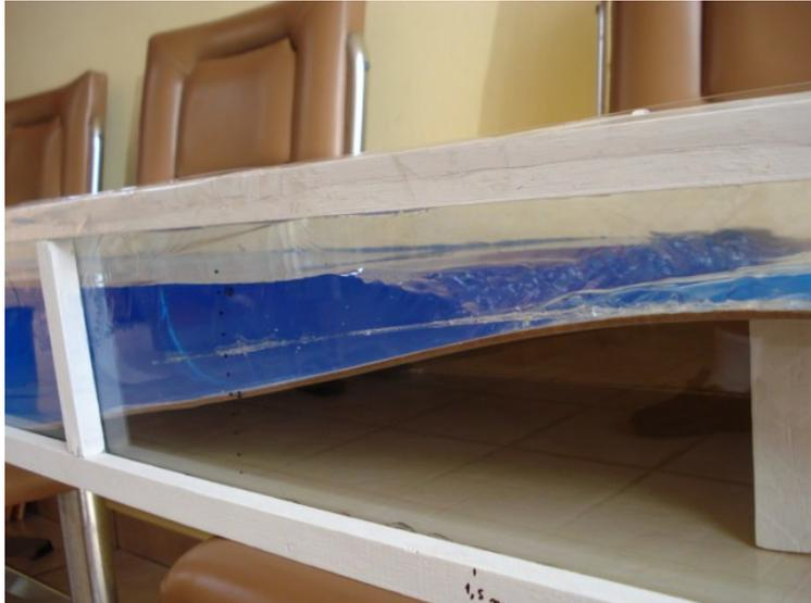
Fig.10: Onda quebrando na parte rasa da cuba
