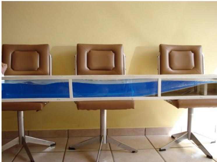
Fig.9: Onda na cuba de profundidade variável
