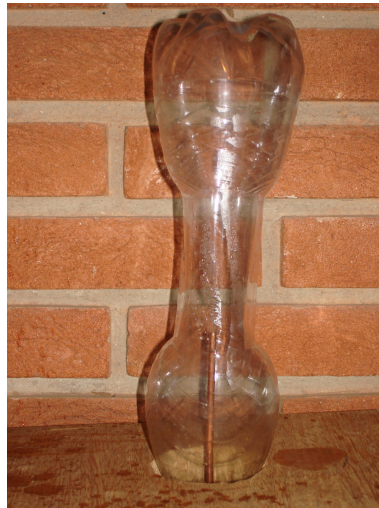
Figura 3 – Deformação sofrida pela garrafa plástica logo após o início do funcionamento do Duplo Chafariz.
