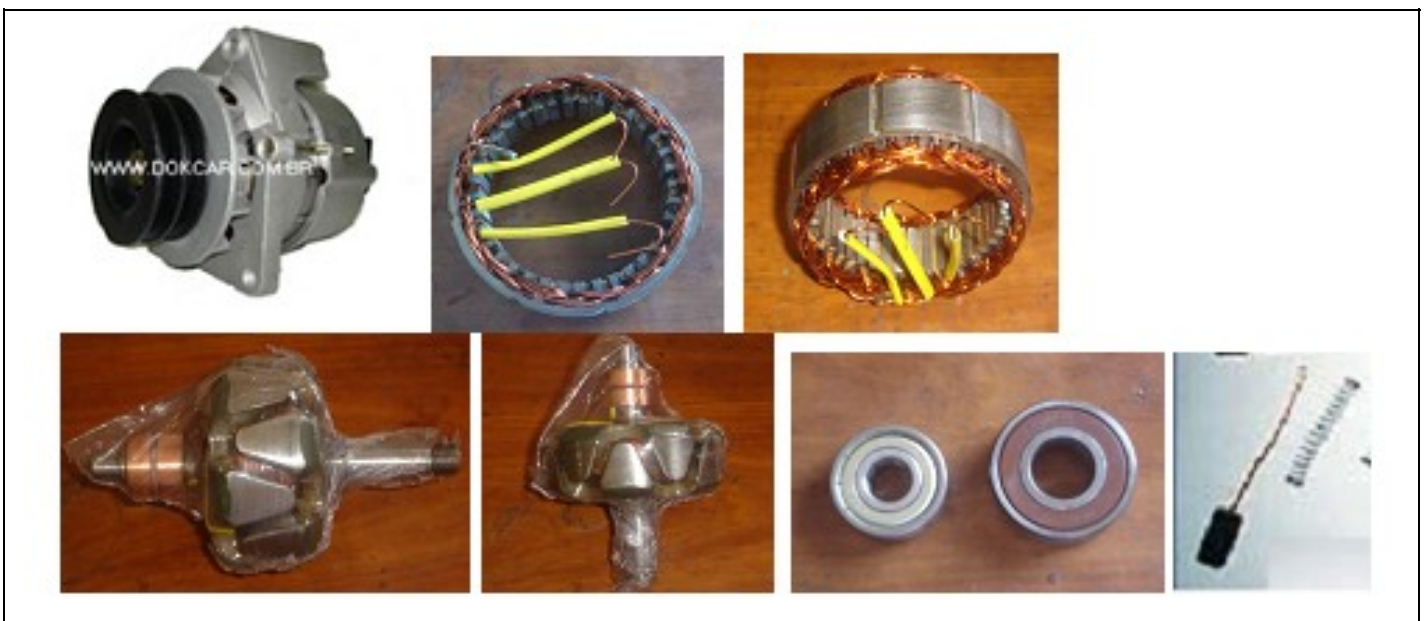
Figura 4.1 Alternador automotivo com alguns de seus principais componentes (Estator, Rotor, rolamentos e escovas de carvão).
