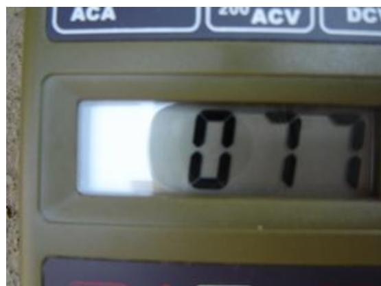
Fig. 157 – Termômetro indicando temperatura no foco da lente
