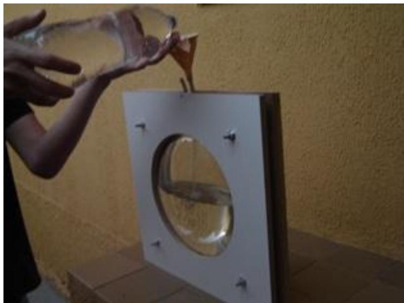
Fig. 8 – Método de enchimento do conjunto.
