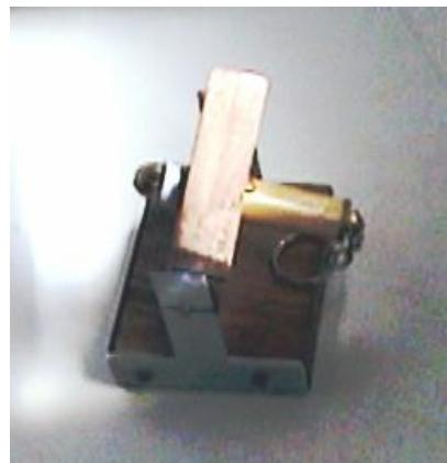
**Fig. 13 – suporte do apontador laser**
