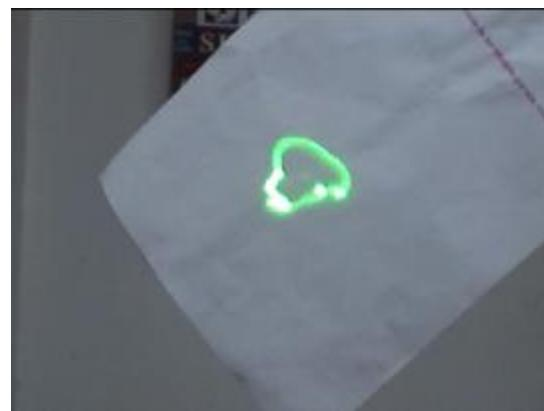
**Fig. 27 – aberração formada após foco**
