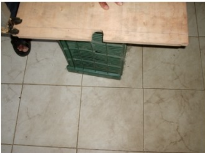
Figura 9: Corte da base de madeira onde ficarão fixados o rotor e estator
