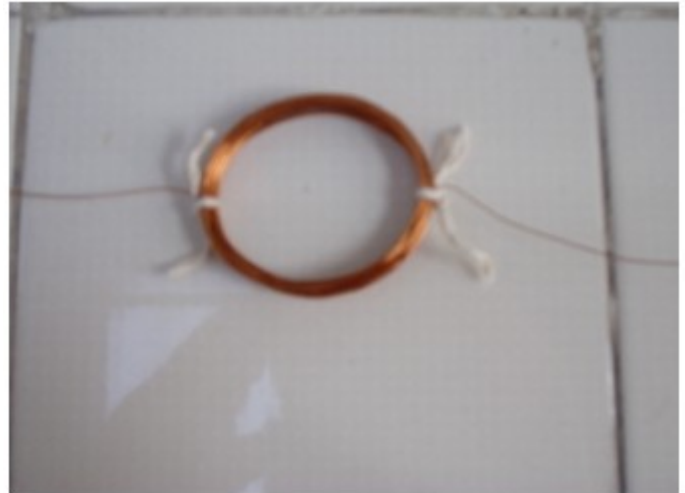
Figura 10: Detalhe da bobina enrolada presa com barbante
