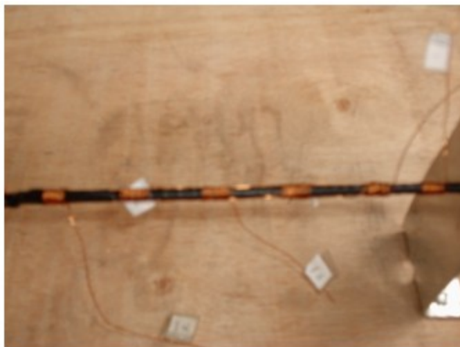
Figura 14: Detalhe dos fios enrolados no eixo onde serão coletadas os potenciais
