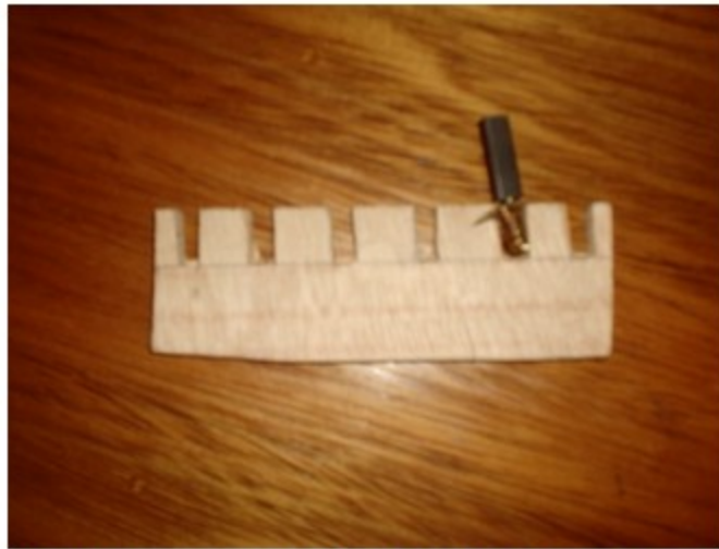
Figura 15: Madeira para a base dos carvões. Detalhe do carvão na madeira
