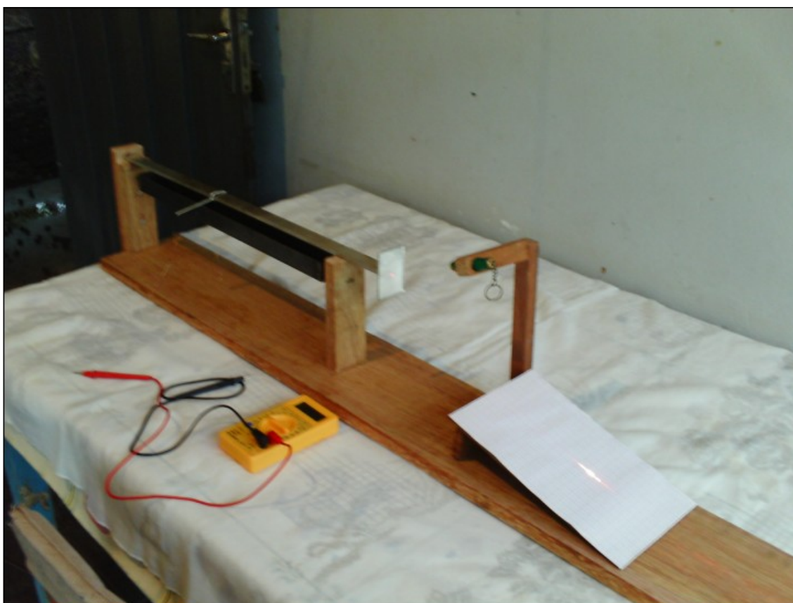
Foto 1: Experimento montado e com o laser ligado. (A barra é de alumínio e no anteparo está colado um papel milimetrado).
