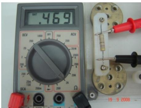
Também fizemos outras medições, tomando uma resistência de  $4,7 \Omega$  foi medido  $4,9 \Omega$ . E com uma resistência de  $840 \Omega$  foi medido  $829 \Omega$ .
