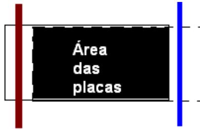
Na figura acima, esquematizamos como será pintado um capacitor de placas paralelas. Temos nesta figura, uma parte tracejada (correspondente a figura de trás de folha) e a parte não tracejada, correspondente a parte da frente da folha, pintaremos todos os locais do retângulo formado por estas (frente e verso da folha). Os bastões azul e vermelho representam os pinos do capacímetro, usado para medir a capacitância.
