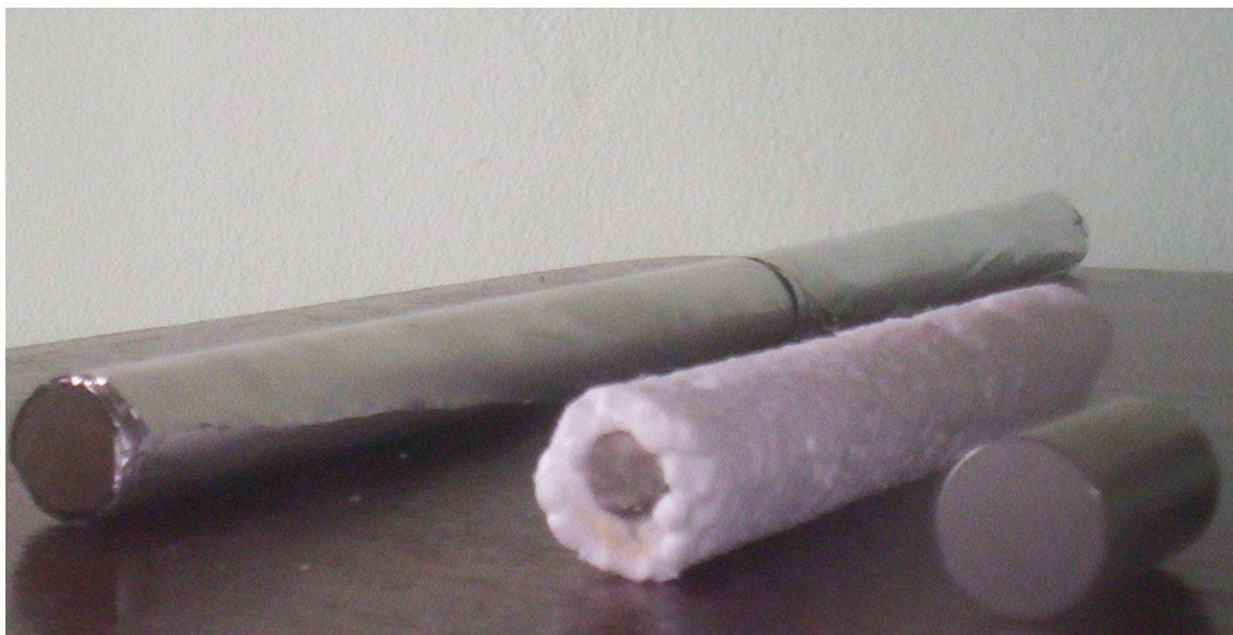
Figura 3 :Cilindros experimentais:madeira revestido de zinco,ferro e isopor e somente ferro.
