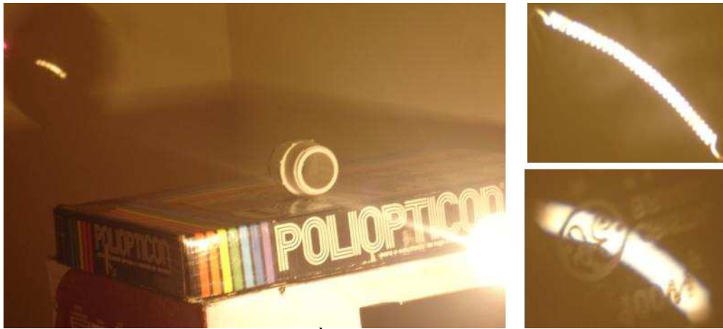
Figura 4. - Projeção de uma lâmpada. À direita: acima, focalizando a resistência; abaixo, focalizando as inscrições do vidro.
