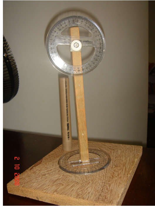
Figuras 2 e 3: Teodolito em processo intermediário de montagem
