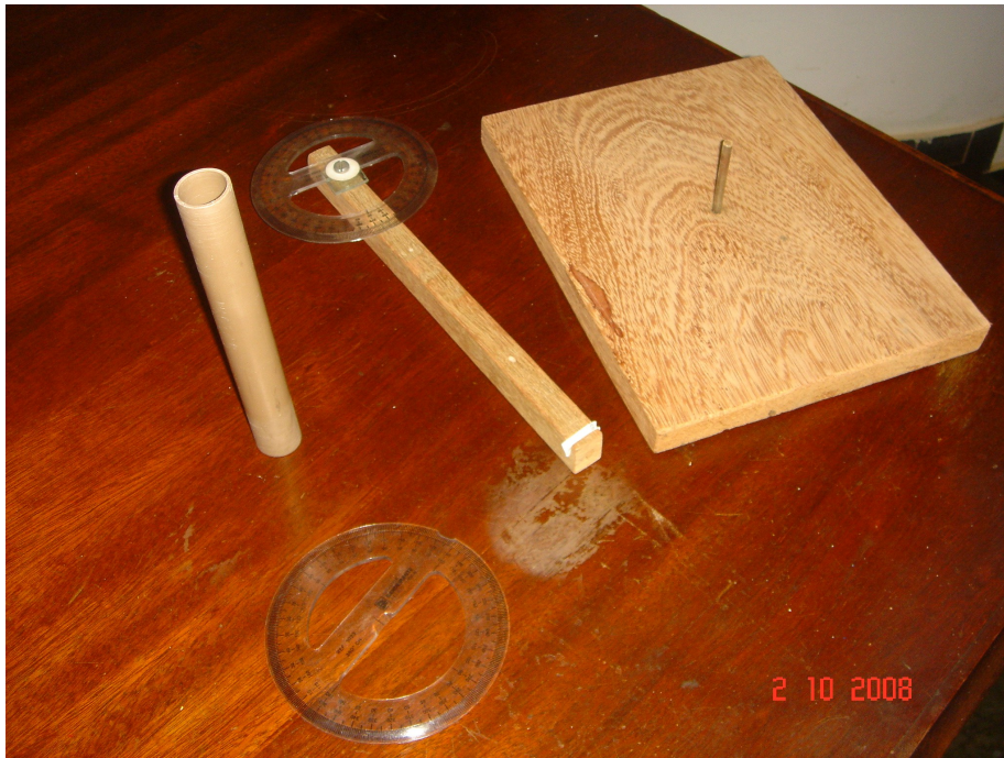
Figura 1: Teodolito em processo inicial de montagem
