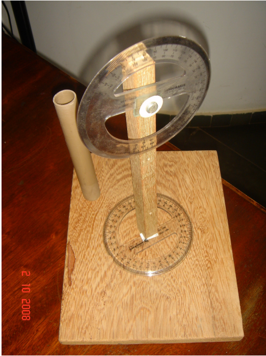
Figuras 2 e 3: Teodolito em processo intermediário de montagem
