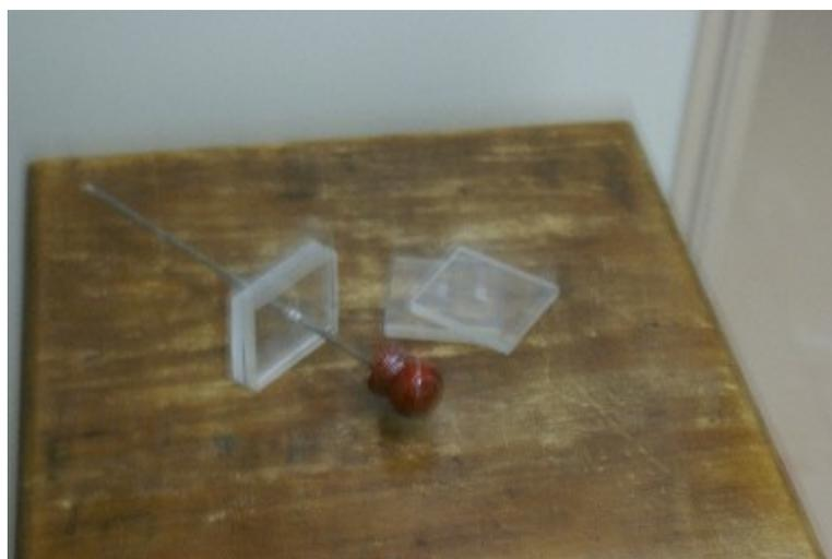
Figura 5. Peças para fixação das hastes.
