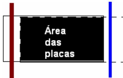
Na figura acima, esquematizamos como será pintado um capacitor de placas paralelas. Temos nesta figura, uma parte tracejada (correspondente a figura de trás de folha) e a parte não tracejada, correspondente a parte da frente da folha, pintaremos todos os locais do retângulo formado por estas
