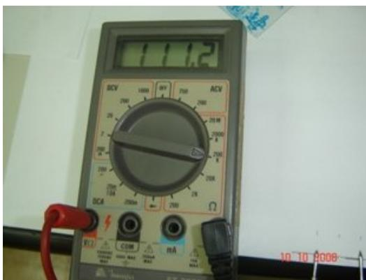
Observe que o crescimento para o maior comprimento  $L$ , há um valor registrado pelo ohmímetro muito maior do que da figura anterior, onde tínhamos uma largura maior. Ou seja, a área é inversamente proporcional a resistência (observe as medições posteriores).
