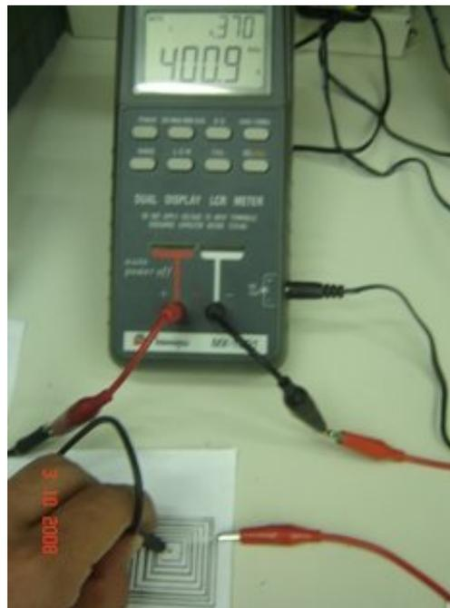
Meu orientador sugeriu e montar um circuito RLC para o cálculo da indutância (para maiores detalhes, olhar seção 2.3). Mesmo assim, não obtivemos algo viável devido ao encontrarmos o limite
