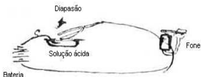
Figura 12: esquema com elementos identificados
