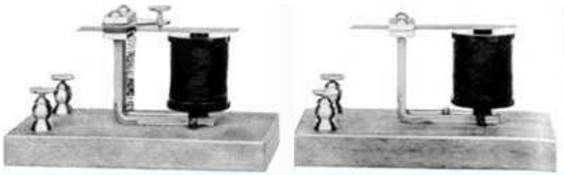
Transmissor (esquerda) e receptor (direita) do telégrafo harmônico de Bell
