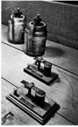
Fotografia dos dispositivos do telégrafo harmônico de Bell, juntamente com duas pilhas da época
