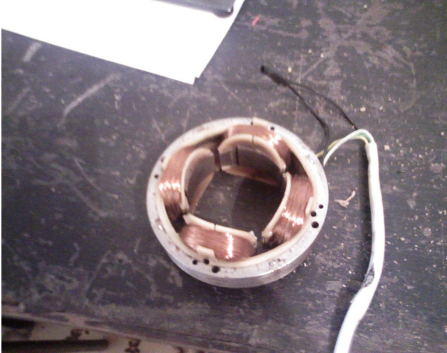
Figura 7: Enrolamento do motor sucateado
