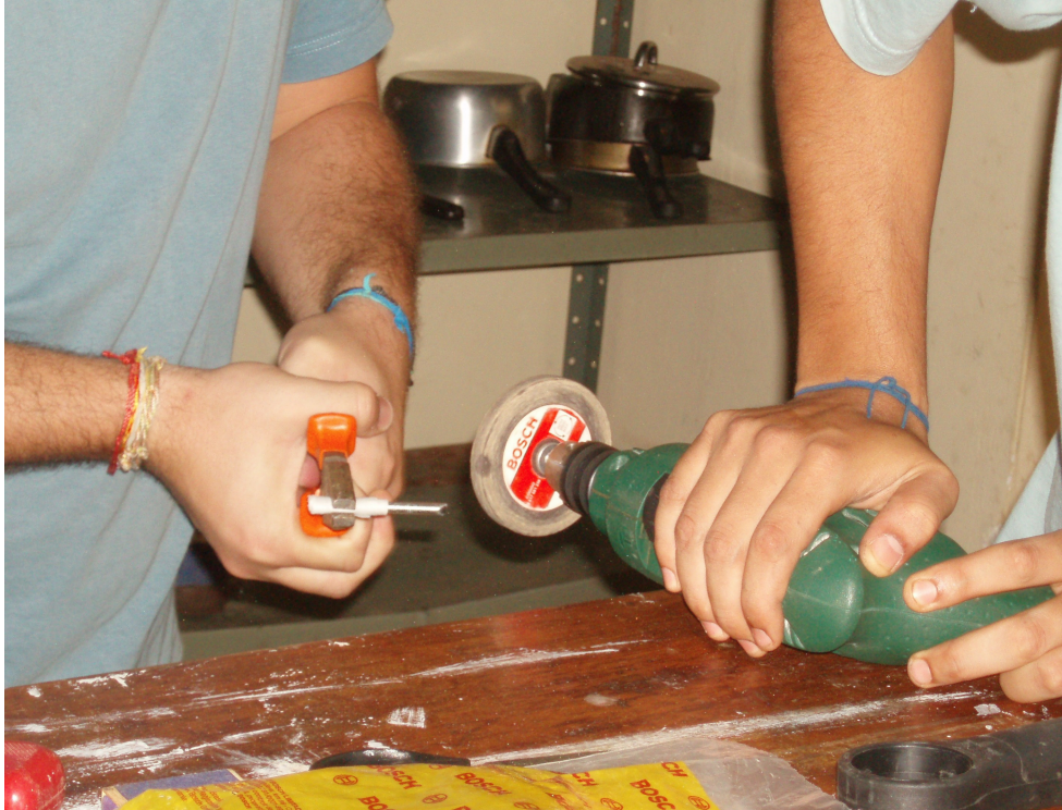
Figura 2: Etapa de apontamento dos parafusos.
