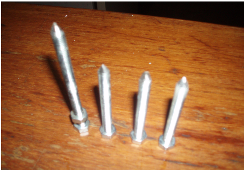
Figura 3: Parafusos apontados com porcas enroscadas.
