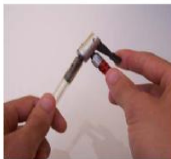
Figura 4. Sistema de propulsão do foguete. (a) Encaixe da mangueira na rolha. (b) Encaixe do tubo de caneta na ponta saliente da mangueira; esse sistema será colocado no bocal da garrafa inteira. (c) Encaixe da válvula de pneu de bicicleta na outra extremidade da mangueira, para uma boa fixação da bomba.
