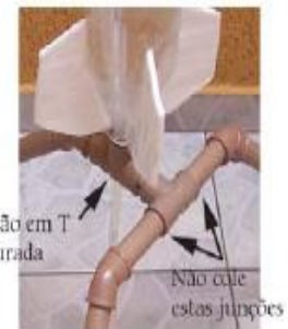
Figura 5. Opções para a construção da base de lançamentos. Em (a), base construída com uma garrafa PET. Em (b), base construída com tubos e conexões de PVC.
