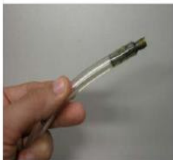
Figura 4. Sistema de propulsão do foguete. (a) Encaixe da mangueira na rolha. (b) Encaixe do tubo de caneta na ponta saliente da mangueira; esse sistema será colocado no bocal da garrafa inteira. (c) Encaixe da válvula de pneu de bicicleta na outra extremidade da mangueira, para uma boa fixação da bomba.
