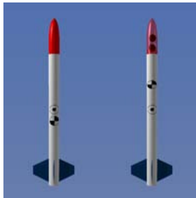
Adicionar peso ao nariz, leva o CG para a frente
