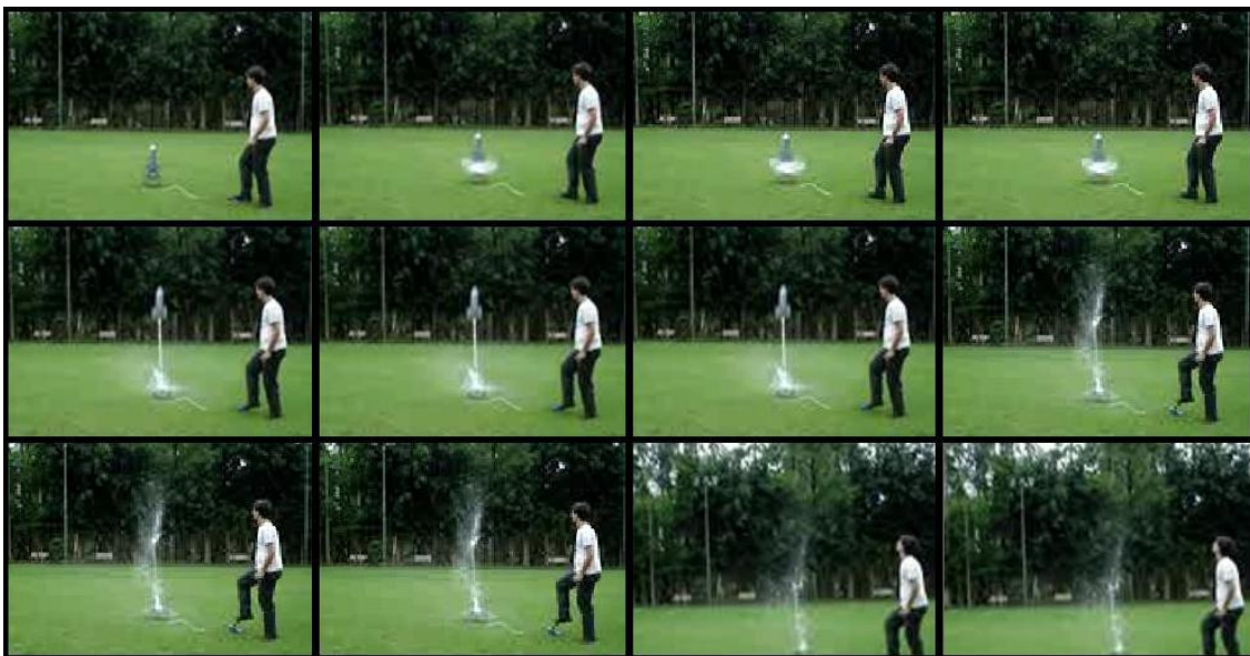
Figura 1: Momento do Lançamento entre 16,32 a 16,76 segundos com intervalo de tempo de 40 ms entre as fotos
