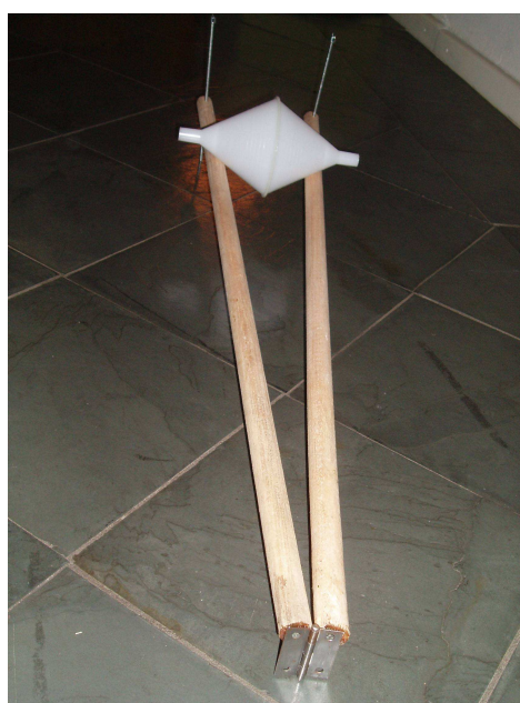
Figura 7: Vista da rama em V com o duplo cone mostrando a dobradiça na junção dos cabos de vassoura e ao fundo a barra roscada com a porca borboleta na ponta.
