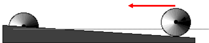
Fig 8 : A figura acima chama a atenção para o avanço do duplo cone sobre a rampa e sua descida quando o mesmo avança da direita para a esquerda em uma aparente “subida” [2] .
