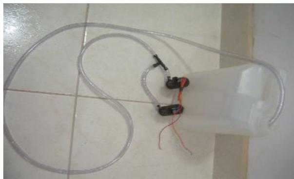
**Figura 6: Reservatório de água, bombas de água e os canos montados.**
