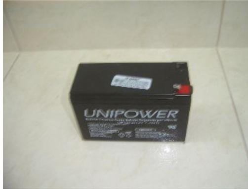
**Figura 7: Bateria retirada do No-Break.**
