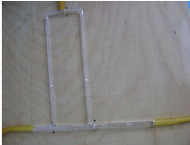
**Figura 8: Tubo de Venturi pronto.**
