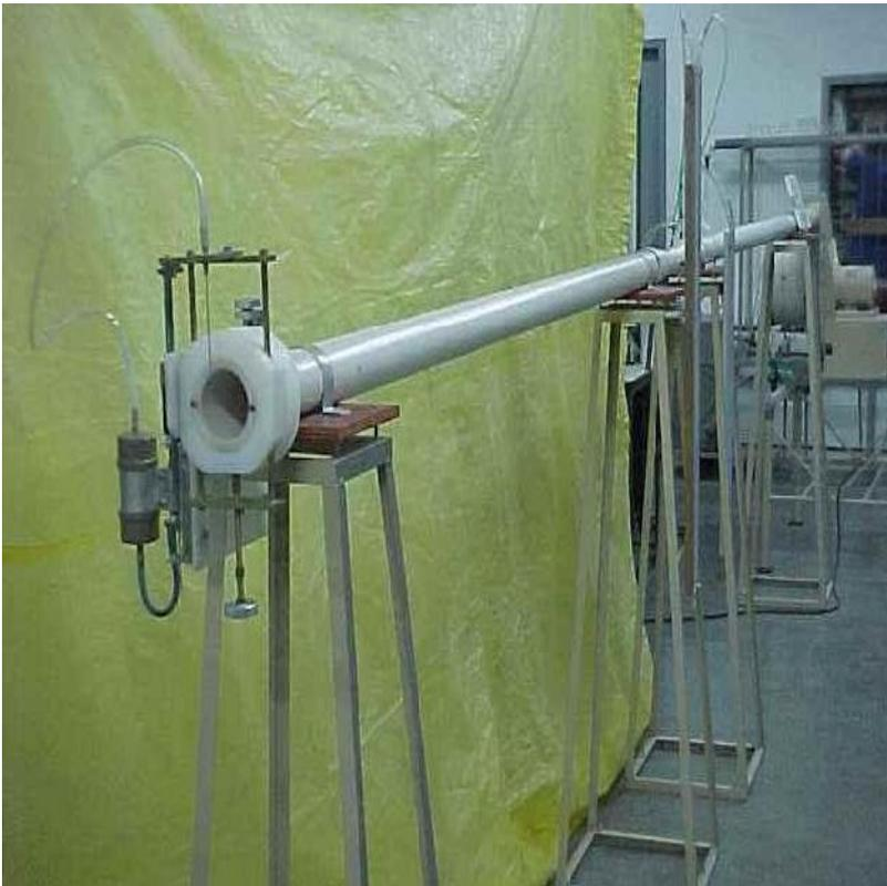
O tubo de Pitot é colocado no final da tubulação ligada ao ventilador radial. Com o tubo de Pitot é possível traçar o perfil de velocidades do escoamento e calcular a vazão. Mudando a frequência do ventilador, pode-se atingir diferentes valores de vazão.
