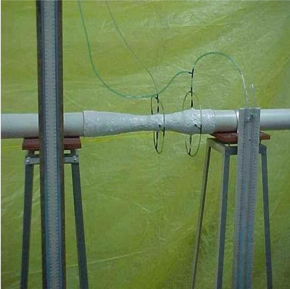
Vista do tubo de Venturi, no meio do equipamento. Junto, os manômetros utilizados para medição.
