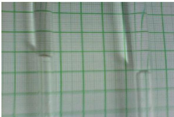
**Figura 12: Diferença de altura nas hastes do tubo de Pitot.**
