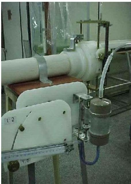
Micrômetro junto ao tubo de Pitot. Detalhe: reservatório de fluido manométrico.
