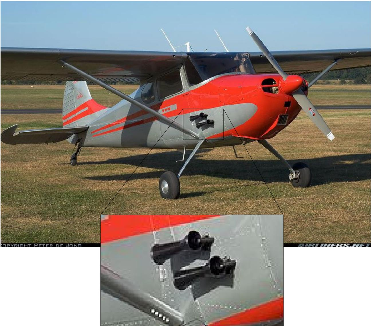
Antigamente, o instrumento acima era usado para medir a velocidade de umavião, é um tubo de Venturi.
