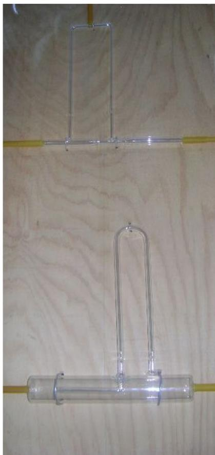
**Figura 10: Tubos de Venturi e Pitot fixados.**
