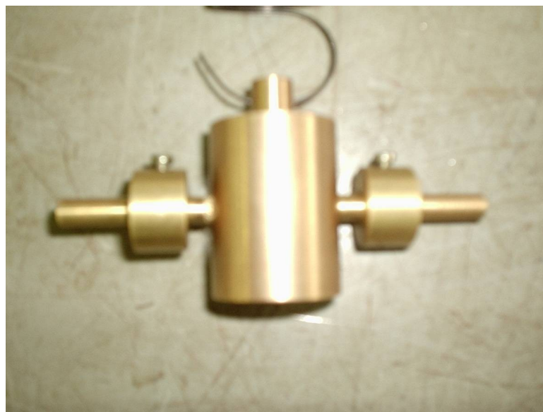
Figura 2: Peso oscilador feito de latão com momento de inércia ajustável.
