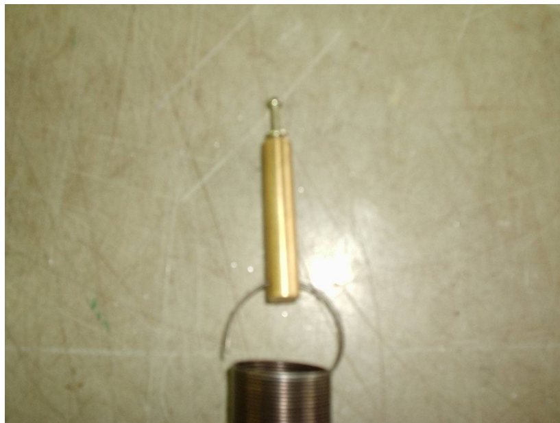
Figura 3: Elo de fixação entre o suporte e a mola, feito de latão.
