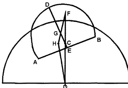
Suponha, em primeiro lugar, que o segmento seja maior do que um hemisfério. Seja ele cortado por um plano através de seu eixo e o centro da terra; e, se possível, suponha que ele permanece em repouso na posição mostrada na figura, onde  $AB$  é a interseção do plano com a base do segmento,  $DE$  seu eixo,  $C$  o centro da esfera da qual o segmento é uma parte, e  $O$  o centro da terra.
