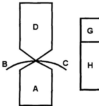
Pois esteja  $A$  completamente submerso no fluido, e representemos o peso de  $A$  por  $G$ , e por  $(G + H)$  o peso de um volume igual de líquido. Tome um sólido  $D$ , com peso  $H$ , e o adicione a  $A$ . Então o peso de  $(A + D)$  é menor do que o peso de um volume igual de líquido; e, se  $(A + D)$  for submerso no líquido, ele vai se projetar de tal forma que seu peso seja igual ao peso do volume deslocado. Mas seu peso é  $(G + H)$ .
