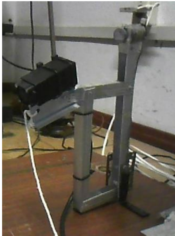
Figura 5. Conjunto laser e espelho para a formação do feixe cônico de luz.
